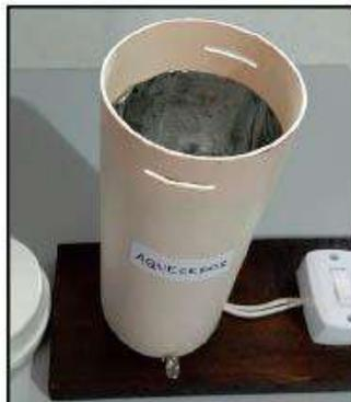
**5º passo:** Utilizando os fixadores em L, fixe o cano PVC no suporte de madeira.
